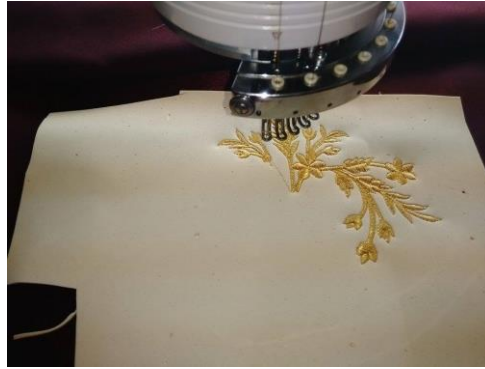
Şekil 38: Sargı parametreleri kullanılarak dijital ortamda tasarlanan Maraş (Dival) işi tekniğinin kabarık durması için işlemenin altına konulan evanın üzerine bilgisayar destekli nakış makinesinde yapılan işlemenin görüntüsü.
