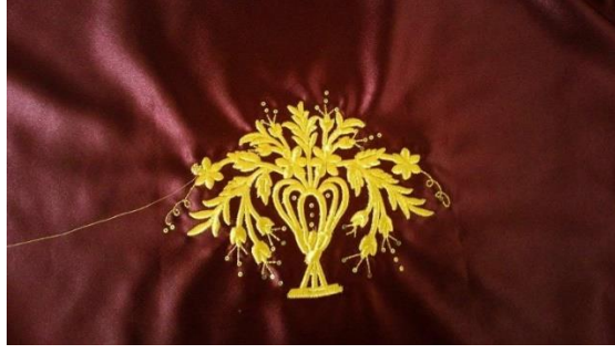
Şekil 40: Sargı parametreleri kullanılarak dijital ortamda tasarlanan Maraş (Dival) işi tekniğinin bilgisayar destekli nakış makinesinde yapılan işlemenin bitmiş görüntüsü.
