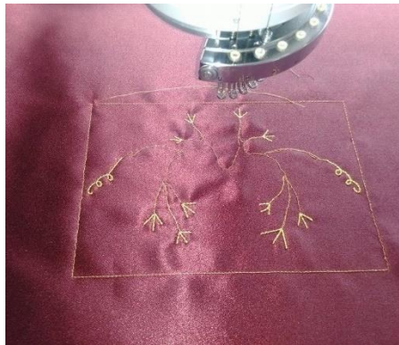
Şekil 36: Sargı parametreleri kullanılarak dijital ortamda tasarlanan Maraş (Dival)ışı tekniğinin işleneceği modelin bilgisayar destekli nakış makinesinde yapılan dekoratif dikişlerin görüntüsü.
