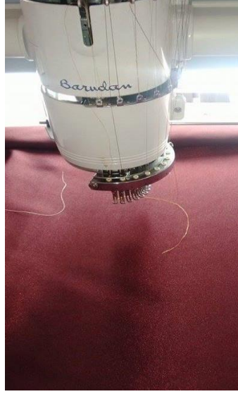
Şekil 34: Sargı parametreleri kullanılarak dijital ortamda tasarlanan Maraş (Dival)ışı tekniğinin işleneceği kumaşın bilgisayar destekli nakış makinesine yerleştirilmiş görüntüsü.
