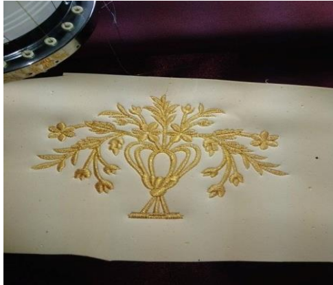
Şekil 39: Sargı parametreleri kullanılarak dijital ortamda tasarlanan Maraş (Dival)ışı tekniğinin kabarık durması için işlemenin altına konulan evanın üzerine bilgisayar destekli nakış makinesinde yapılan işlemenin bitmiş görüntüsü.
