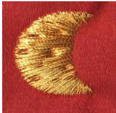
Şekil 24: Sargı parametreleri kullanılarak dijital ortamda tasarlanan delikli sarma tekniğinin bilgisayar destekli işleme makinesinde işlenmiş görüntüsü.
