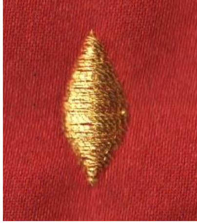
Şekil 5: Sargı parametreleri kullanılarak dijital ortamda tasarlanan düz sarma tekniğinin bilgisayar destekli işleme makinesinde işlenmiş görüntüsü.
