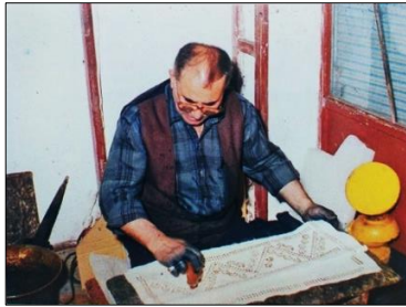
Görsel 26. Hıdır Oral Usta Bervanik Baskı atölyesinde tahta kalıplarla mum baskı yaparken, (Şahin, 2013, s. 7)
