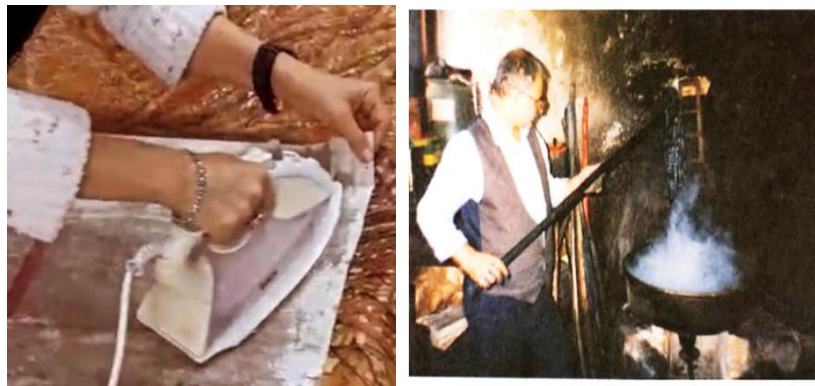
Görsel 35. Buharsız kızgın ütüyle mumun alınışı, fikse yapımı, (Aydoğan arşivi, 2023) Görsel 36. Hıdır Usta, Bervanik kupon kumaşlarının kaynar suyla mumunu alırken (Şahin, 1995, s. 7)
